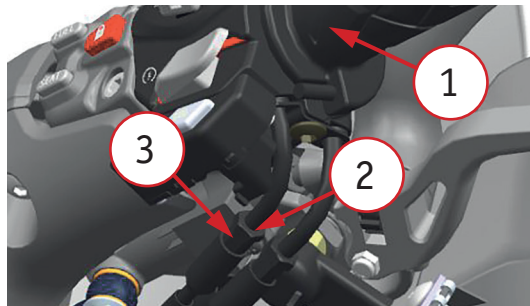
Фото 2.15. Регулировка троса газа: 1 – ручка газа; 2 – стопорная гайка; 3 – регулировочная гайка.
