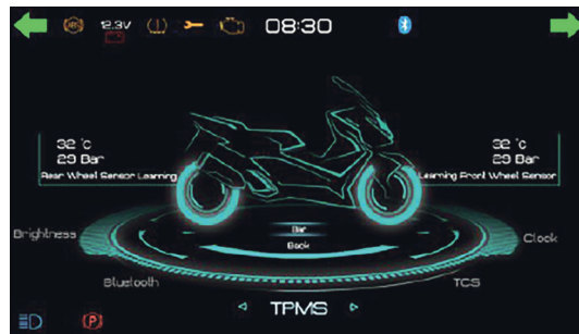
Фото 2.12. Панель контроля давления.
