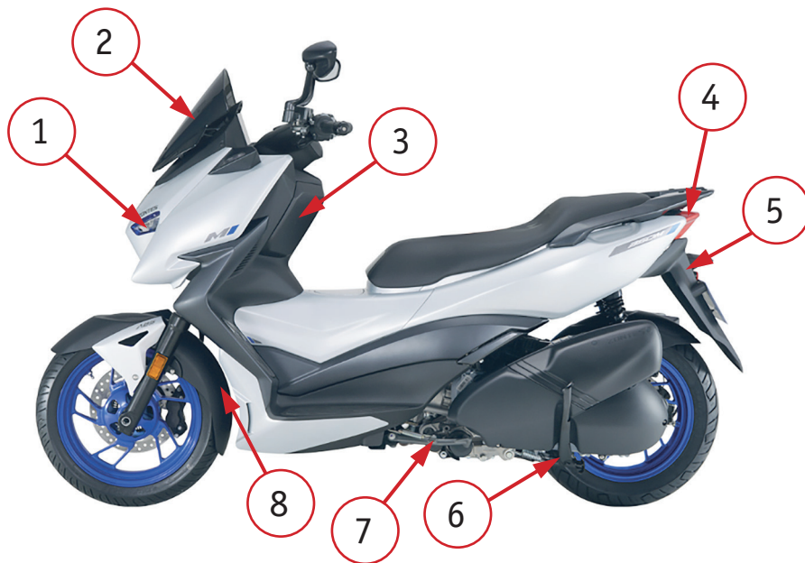
Фото 2.3 Вид слева: 1 – передние поворотные огни; 2 – ветровое стекло; 3 – левый ящик; 4 – задний фонарь; 5 – заднее крыло; 6 – центральная подставка скутера; 7 – боковая подставка; 8 – переднее крыло.
