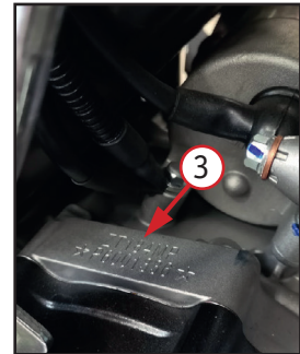
Фото 1.2. Справа на двигателе нанесен серийный номер двигателя – 3
