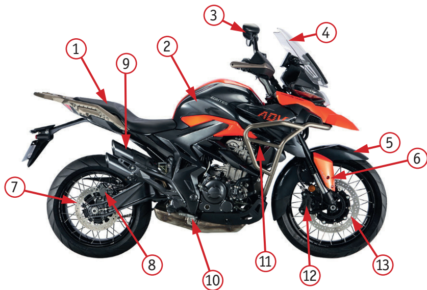
Фото 2.2. Вид справа: 1 – сиденье; 2 – топливный бак; 3 – зеркало заднего вида; 4 – ветровое стекло; 5 – крыло переднего колеса; 6 – защита правого педа; 7 – задний тормозной диск; 8 – задний тормозной суппорт; 9 – глушитель; 10 – педаль заднего тормоза; 11 – катушка зажигания; 12 – передний тормозной суппорт; 13 – передний тормозной диск.
