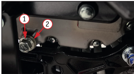
Фото 4.5. Слив моторного масла: сливной болт – 1; шайба – 2.
