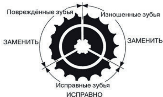
Рисунок 4. Износ звезд.
