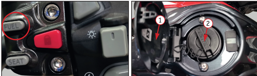
Фото 2.22. Открывание крышки топливного бака моделей ZT125-U/U1, ZT200-U1, ZT350-R/R1, ZT350-X/X1, ZT350-T, ZT350-GK, ZT350-VX, ZT350-V1 (с бесключевым доступом): «FUEL» - кнопка открытия внешней откидной крышки; 1 – внешняя защитная крышка; 2 – крышка топливного бака.
