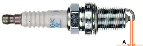
Фото 4.4. Зазор между электродами свечи зажигания
