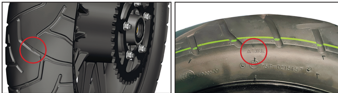
Фото 3.11. Расположение меток износа шины
